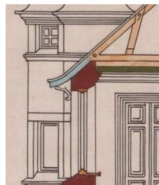
Металлические кронштейны венчающего карниза. Лицевой Ю-3 фасад. Фрагмент чертежа поперечного разреза (проект 1906 г.)
